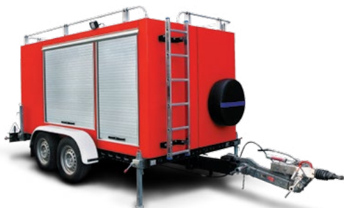
PRZYCZEPA Z AGREGATEM PROSZKOWYM TRAILER WITH DRY POWDER EXTINGUISHING UNIT
